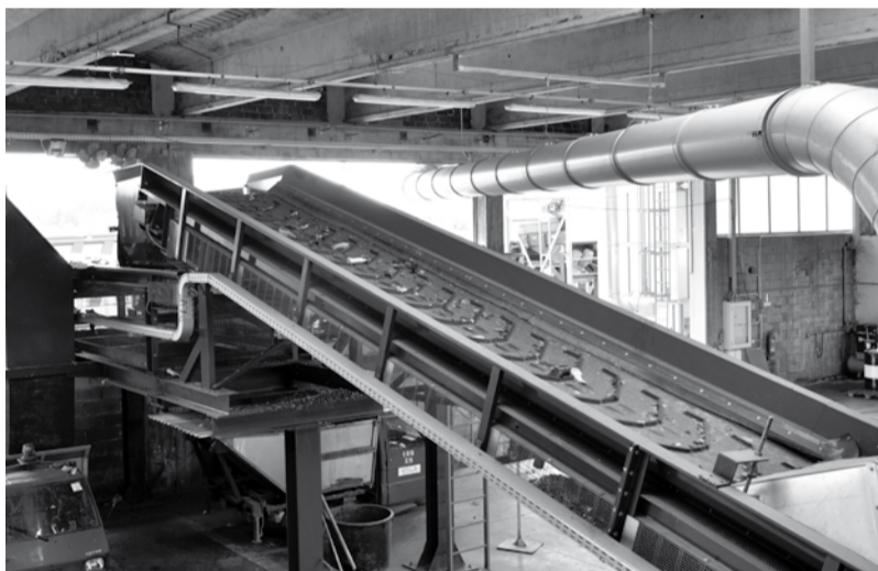
Il nastro dopo l'aspirazione della plastica
