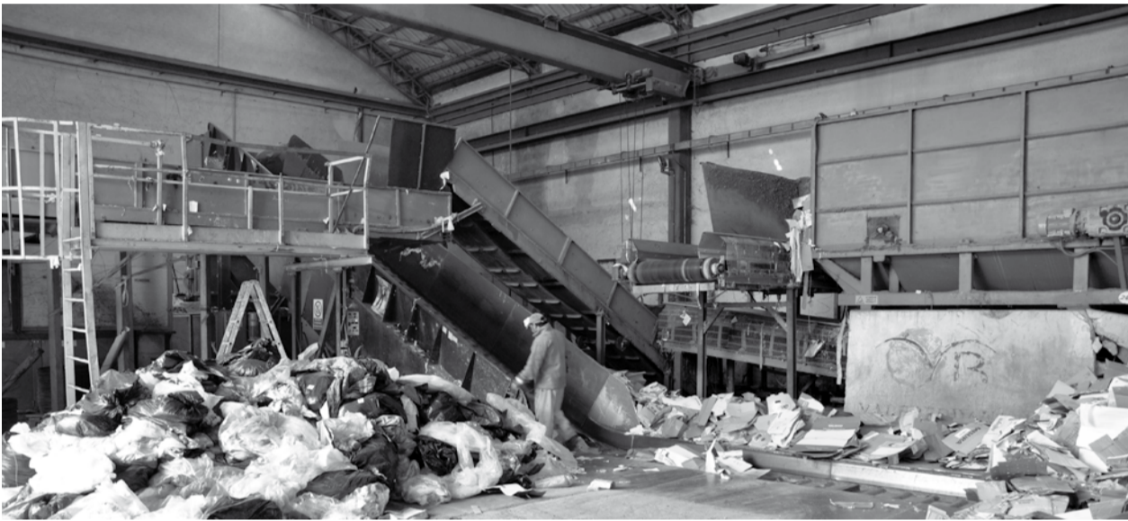
Questo macchinario trasporta carta e cartone verso la pressa, un operatore elimina la plastica
