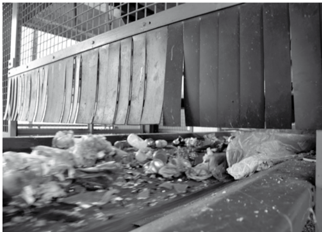
Un'elettrocalamita sopra il nastro attrae il ferro
